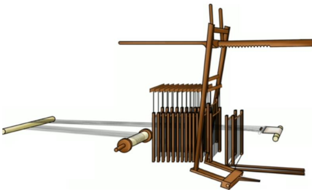
图 10 曲轴式多综织机局部细节展示图
