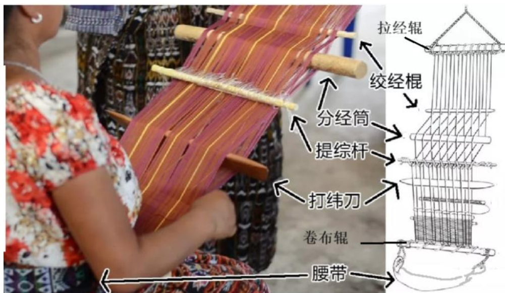
图 2 腰机结构示意图
