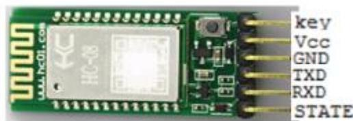
图 0-18 蓝牙串口通信模块
