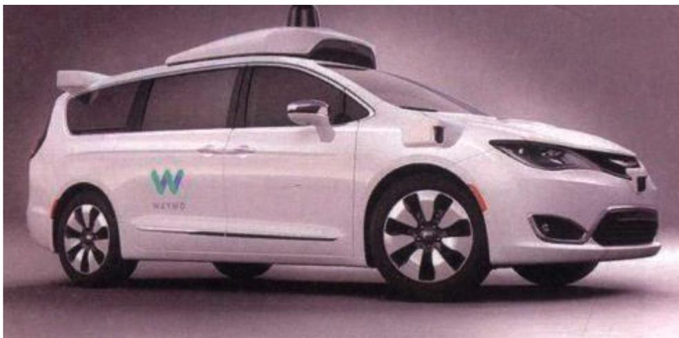
图 0-15 利用 MPV 改造的无人驾驶概念车
