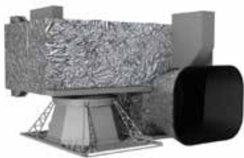
图 1-3 先进的静止轨道辐射成像仪是“风云四号”静止气象卫星的主要载荷之一
