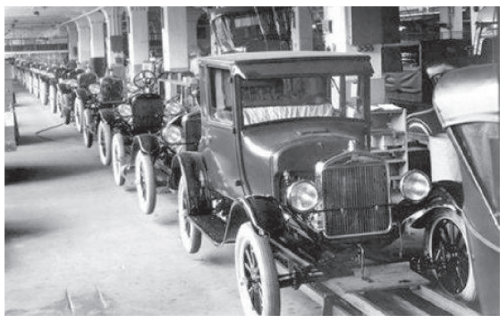
福特 T 型汽车流水生产线
